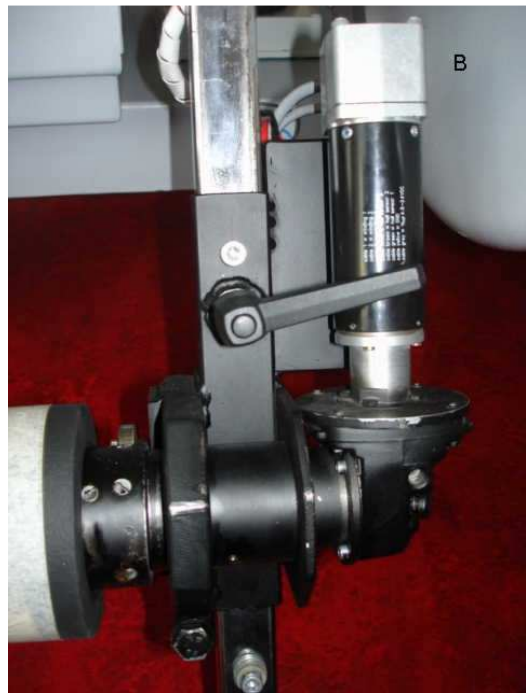
Graphik B Detailansicht des vibrationsgenerierenden für das Quadricepstraining Motors
